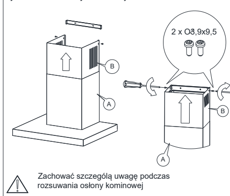
Rys. 9 Montaż osłony kominowej.
